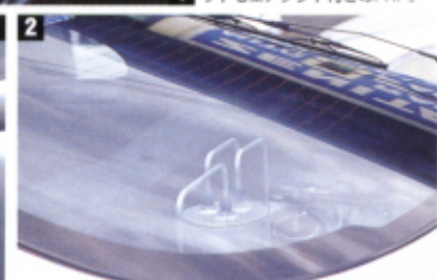
①社製1の Cockpitである。当然のことながら全国レベルでのドラッグチャレンジ予定。②アクリル製のリヤゲート越しに見えるのはコレクタータンクと燃料システム。キレイに作り込まれているので思わず魅入ってしまう。ボンネットもエアダクト付きのFRP。
