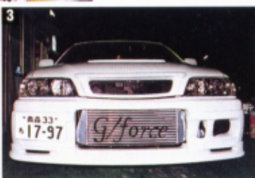
② エンジンは2JZの新品ショートプロ ックをドッキングさせ、Gフォースオ リジナルの鍛造ピストンが組まれる。 ヘッドもポート&燃焼室、バルブと鏡 面&加工仕上げされる。③ インターク ーラーはブリッツ製の3層。インジェ クターは850ccでパワーFCで制御。
