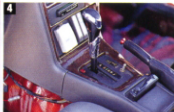
④ATはオペロンオイルを使って油圧を上げたもの。もう4年は全開ダッシュを繰り返しているが、もっている。これまでのトラブルは扱いミスで水温が上がったことくらい??
