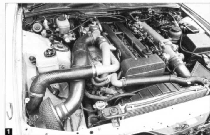
①1JZはツインターボなので、バルブの設置場所は2個のタービンから均等な距離&最短のホースレイアウトができる。こういう細かい部分が必要! ②ブーストアップにはプラグ交換がお約束。購入した中古車が、すでにプラグを交換していても、自分がいじるときは新品に交換だ。
