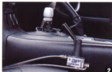
①これがボグのブレーキパッド。従来のパッドの概念とは違って、前後のバランスを重要視して製作されたもの。サーキット走行向けに開発。②テスト時には、前後のブレーキバランスをチェックしながら、最適なバランスになるようにパッドのバランスをチェック。
