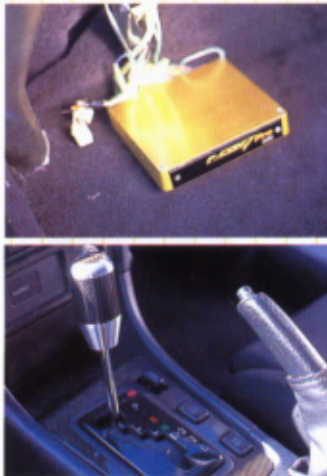
④パワーアップされたエンジンにATミッション組み合わせるなら、最低でもATオイルクーラーは追加したい。 ⑤Vプロを使うことで、ハーネスの問題は一切なくなる。ただし、ATミッションに対しては断れない……。
