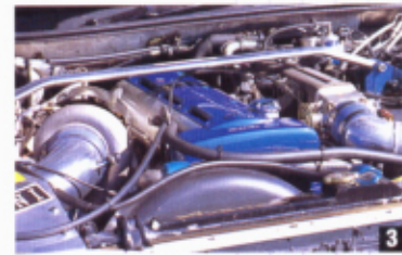
①ATミッションのため、タービンサイズをゆやみに大きくしてしまうとスタートがツラくなることから、TO4Rを選択している。②スロットルボディの調整は、SR16VEに交換することで対応している。コストも安く済むし、80の口径は使いやすい。
