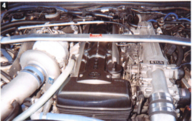
①エンジンは2年前に製作され、10万kmを走ってノントラブル。②タービンがT78なので、若干ターボラグが気になる?③サーキットでの周回や最高速等に使用されるから、冷却対策はシッカリと!
