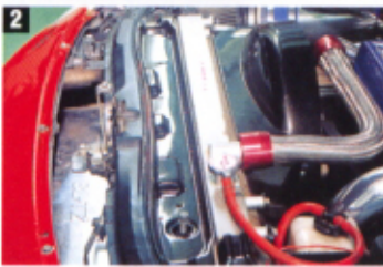
1 ブリッツ3層インタークーラーのうしろ側にセットされているオイルクーラー。2 ラジエーターはヤシオファクトリーの大容量タイプ。連続走行対策もバッチリ。3 エアロだけでなくターボチューンもT&E製。
