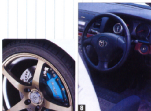
⑧コクピットには、60φのワーニング連成計がセットされる。⑨ブレーキは性能アップを目的にプロジェクト製の6ポットキャリパーキットが組まれている。
