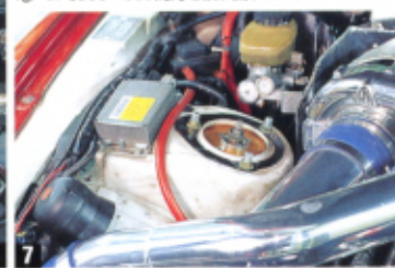
8 レカロSR II&ナルディステアの室内には、追加メーター類がセットされる。7 ショックはPCRスペックDの車高調にTRDの強化ブッシュを組む。フロント&リアのメンバーは後期型が移植されている。9 プーレスト1.5kg/cm 2 で500~600馬力を絞り出す2JZ。
