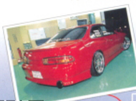
10 VERTEX製のリヤアンダースポイラーにレジフォール製フルチタンマフラーをセットする。11 HUNKのホイールの内側には80スープラ用キヤリパー&ローター。
