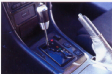
●アンフィニの富田さんは「Vプロにすると純正コンピュータが行なっている点火やアクセルの制御ができなくなるため、ATミッションに対しては厳しくなる」と言う。
