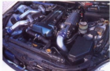
●2JZ本体は、ガスケットすら交換していない。このエンジンに、ASモリオリジナルのエキマニやバイピングキットを使い、R34GT-RのN1タービンをツインで装着。
