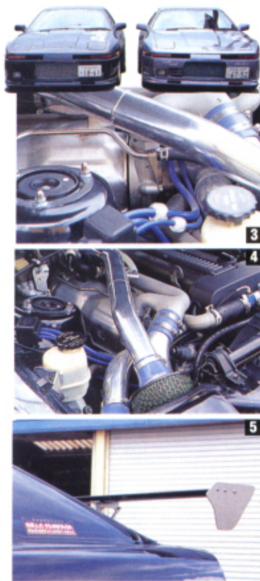
①HKSのSタイプインタークーラーをセットしたフロント部分だが、パンパースボイラーを最大限にカットし、しかもサイド部に導風板をセットしている。②エンジンはツインサクシヨンタイプのブーストアップ。 ③HKSのEVCを使い、ブースト設定が1.1~1.2kg/cmあたりでセットする。④ここで効果を発揮するのがインテーク側のツインサクシヨン。これが非常に効果的なのだ。⑤リヤウイングまでそっくりな70スーパーは、双子の令村兄弟のマシン。外観はクリソツで、ブーストアップの程度も同じ。強烈に競り合っている??
