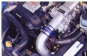
①マークIIの110系とベロツサは基本的に同じパワーユニット&周辺機器設定となっている。当然のことながら、スロットルはETCSの電子制御タイプ。②通常の仕様では、風量がたくさん入るとフェューエルカットが働く。だが、Vプロでエアフロ制御にするとなんとか……開発中。
