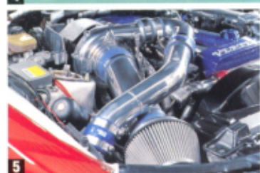
4 VERTEX製フロントバンパー&サイドステップ等を装着する。フェンダーは叩きだし。5 タービンはK27の3667MOJKA。600馬力のパワーを絞り出す。
