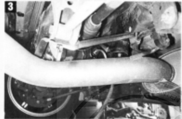
①パワーがあるクルマだけに、デフオイルはマメに交換してやりたい。激しく走っているクルマは、特に注意すること。②抜いたオイルに金属粉が混じっているようなら、オーバーホールが必要かどうかチェックしよう。③この車種のデフオイル注入口は、プロペラシャフト側の、ちょっと入れにくい位置にあるのだ。
