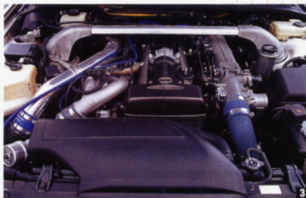
③ブリッツの3層インタークーラーをセットするフロントカバー部分。④このタイプでは、輸出用のタービン&フロント補機類がセットされている。これは現在入手不可能といわれている。この状態でのパワーは550馬力を発揮。
