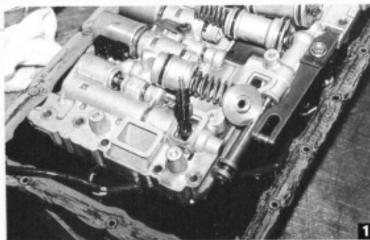
①これが油圧制御を行なうバルブ部でATの要。②ATチューンは油圧アップやクラッチ&ブレーキ枚数変更を行なうもの。MTの強化クラッチ交換と同じような原理。ギヤには強化は無く、あまりにもハイパワーだとギヤが負けることもある。③クラッチの摩材は、ATFとの相性もある。グレードが指定されている場合はそれに従うこと。
