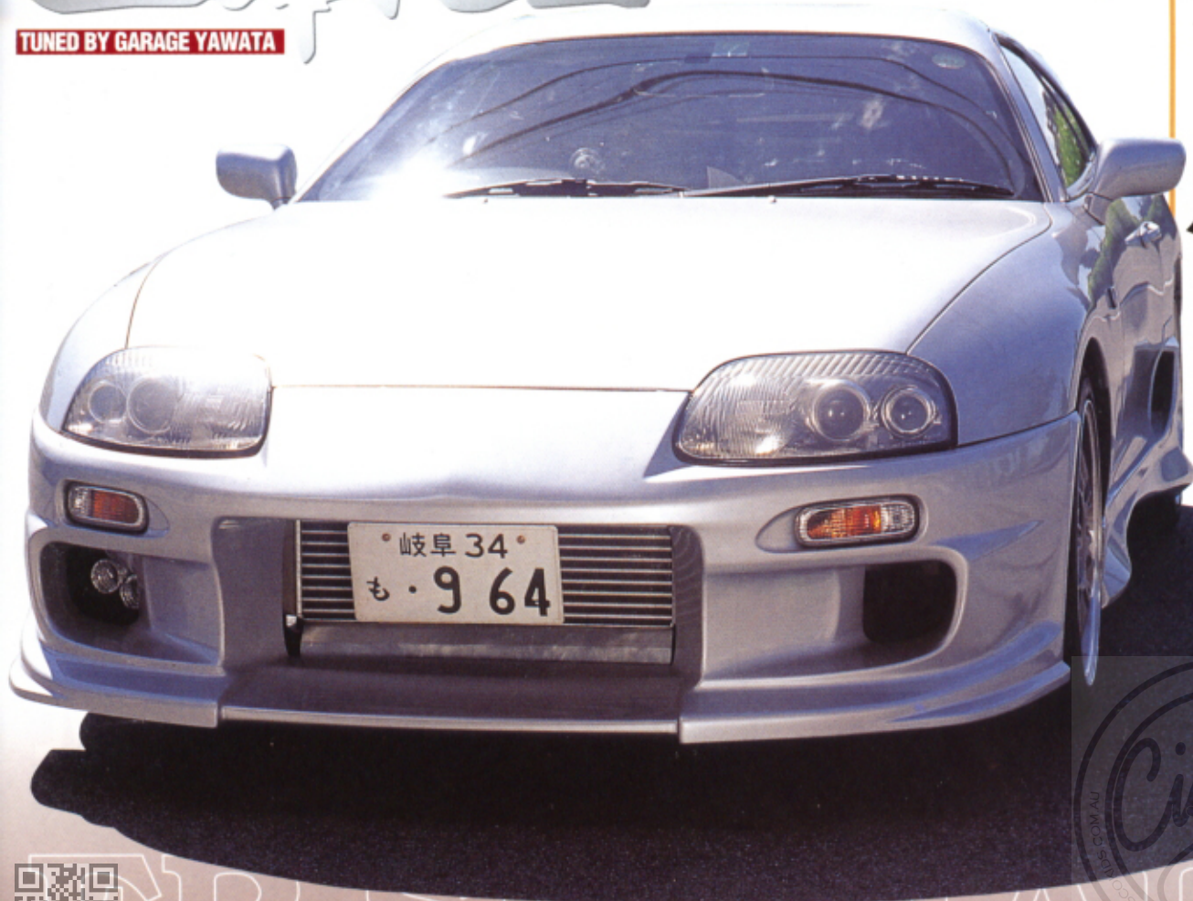
①前置きのインタークーラーは、ブリッツ製のコアを使い、パイピングを自作して装着する。②タービンはGT2835を選択。③NAではなかったタービン用に冷却システムをしっかりと行なっている。
