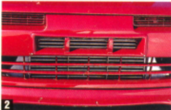
①TO4Rタービンを1.8kg/cmのブーストで駆動して670馬力をマークする2JZ改2インタークーラーはトラストの3層タイプ。
