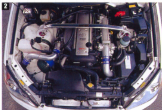
①マークIIの110系とベロツサは基本的に同じパワーユニット&周辺機器設定となっている。当然のことながら、スロットルはETCSの電子制御タイプ。②通常の仕様では、風量がたくさん入るとフェューエルカットが働く。だが、Vプロでエアフロ制御にするとなんとか……開発中。
