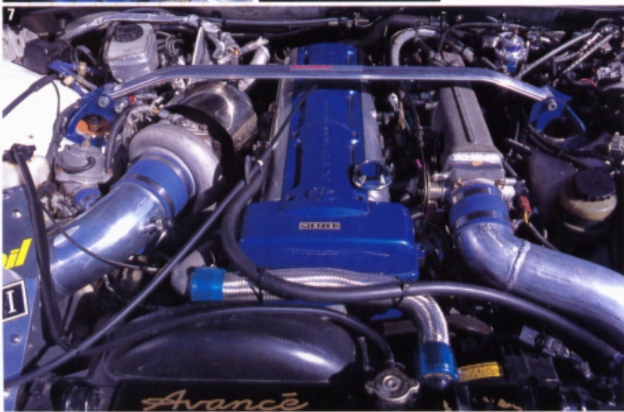
⑦オイルパンの交換以外はボルトオンで搭載できるのが魅力。Vプロを使い、フロントパイプなど細かい部分だけの変更で3ℓのトルクを手に入れることができる。 ⑧HKSのツインパワーは、Vプロと組み合わせることで能力をさらに発揮する。低速から効くのがいい! ⑨パワーアップには欠かせないインタークーラーは3層タイプ。オイルクーラーはエンジンとATが追加される。何度かの仕様変更を繰り返した結果、現在の仕様に落ち着いた。
