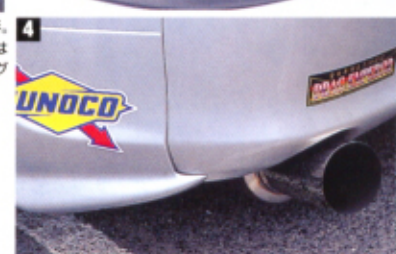
③ドラッグ指向だけにステッカーチューンも派手。エアロもパッチリデカールされる。④マフラーはZENITANIオリジナルの90φ口径を持つドラッグSPLタイプ。EXマニはブリッツ手曲げ。
