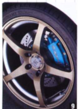
⑧コクピットには、60φのワーニング連成計がセットされる。⑨ブレーキは性能アップを目的にプロジェクト製の6ポットキャリパーキットが組まれている。
