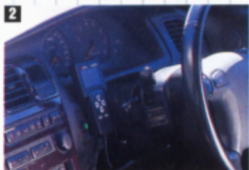
①Dジェトロ仕様となった1JZ改1.5J仕様。②パワーFCを使用してフィッティングするフルコン制御。700馬力のパワーを制御するのは、細やかなセットアップ。これがないとパワーだけでは使えない。
