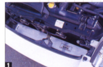
①インタークーラーはポン付けタービン仕様ということもあってHKSのSタイプを装着。450馬力くらいならこれでOK。②電子スロットルのETCSは、FコンVプロを使うことでフェューエルカットが入るのを防ぐ。
