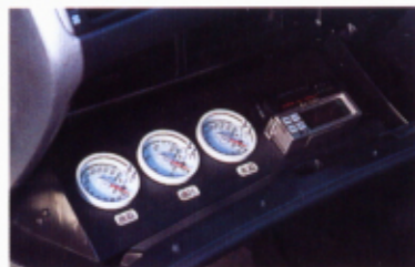
●エンジン制御はFコンV、ブーストはEVCプロでコントロールし、1.3kg/cm 2 の設定。これでパワーはキッチリ500馬力。ATはクーラーのみ装着した以外、無加工のノーマルだ。
