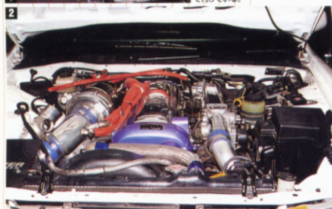
② エンジンは2JZの新品ショートプロ ックをドッキングさせ、Gフォースオ リジナルの鍛造ピストンが組まれる。 ヘッドもポート&燃焼室、バルブと鏡 面&加工仕上げされる。③ インターク ーラーはブリッツ製の3層。インジェ クターは850ccでパワーFCで制御。
