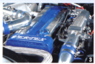
1 ブリッツ3層インタークーラーのうしろ側にセットされているオイルクーラー。2 ラジエーターはヤシオファクトリーの大容量タイプ。連続走行対策もバッチリ。3 エアロだけでなくターボチューンもT&E製。
