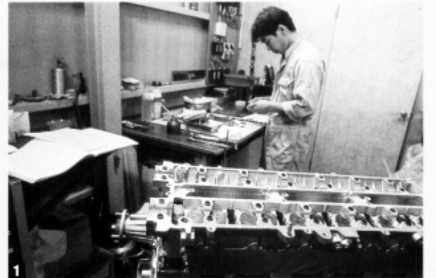
①2走行距離10万kmのブーストアップ仕 様も、腰下には問題なしで、ピストンリ ングとポンプ類の交換のみで済んでいる。 ヘッドは、バルブ交換やシートカットな ど、常識的なオーバーホール作業をして いる。カムにも異常なし。②1JZ&2JZ のオーバーホールを引き受けてくれるア プフラッグ。エンジンを開けないこと は、費用は予想できないが、軽症の場合、 エンジン税込み50万円くらいから。
