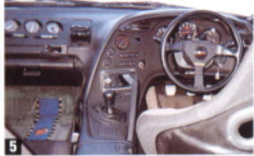
④T78タービンを中心にセットした2JZエンジンは1.0kg/cm 2 ブースト時に470馬力。1.5kg/cm 2 で600馬力をマークする。⑤シートはレカロのSPGをセットする。⑥ダッシュにセットされたメーター類や、FコンV、AICのコントローラーは、現地でのセッティング変更時に使用される。⑦ショックはティンHRダンパーを中心に、それほど難らずにセットアップ。
