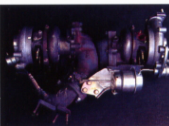
●アクチュエーターがセットされている部分はこのようになっている。Eリングが入っているのは、裏側となる。ちょっと作業がしにくいので手探りでやる。
