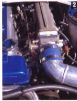
③2JZに換装する場合は、オイルパンをマークII用に交換すれば、加工なしで搭載することができる。ATミッションなら中古の相場も安いので、最終的にはコストパフォーマンスは上かもしれない。
