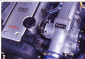
①インタークーラーはポン付けタービン仕様ということもあってHKSのSタイプを装着。450馬力くらいならこれでOK。②電子スロットルのETCSは、FコンVプロを使うことでフェューエルカットが入るのを防ぐ。
