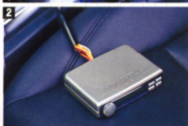
①ETCSの電子スロットルシステムは、ブーストアップ度が高くなると、チューンの妨げとなる。②EVC IIIでブースト圧をコントロールする。③FコンVプロを使って、エアフロレスのデジタル仕様とすると、電子スロットルはなんとクリアできるが……現在開発を急いでいる。
