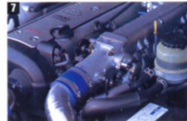
⑤パイピングキットも、オートサービスMORI製で 3万4000円だ。⑥エンジンは、まったくのノーマ ル。タービン交換と補機、スロットルのみを交換 し、ブースト0.7kg/cm 2 で312馬力。まだまだパ ワーアップできる。⑦レスポンスの悪い110系ス ロットルを、100系の機械式に交換。
