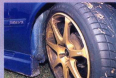
●ツライチのシャコタンにするとフェンダーのツメ折りは必要。また、フロントはインナーフェンダーの干渉があるはず。このとき、フェンダー裏にゴミが入らないよう後ろ側は残した方がいい。
