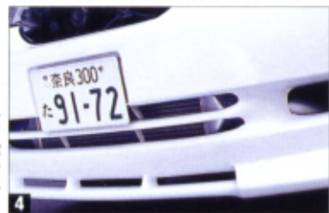
③Vプロを使うことで実現したエアフロレスのダイレクトインタークーラーシステム。これがポイントとなる。④インタークーラーをバンパー裏にセットする。スペースが少ないうえだ。
