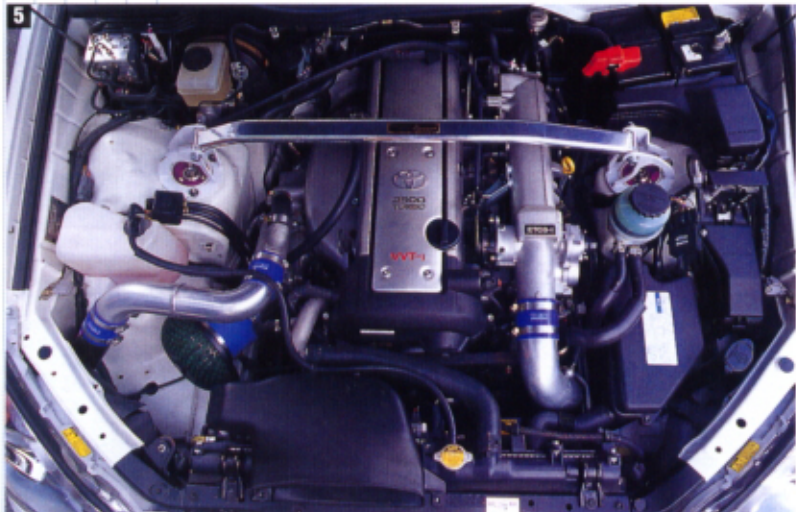
⑥ダイレクトサクションは、HKSのレーシングサクションを使用。インタークーラーとの組み合わせで、ノーマルJZは380馬力を出力する。⑧燃料&点火のコントロールはFコンVプロを使う。助手席右下にセット。⑦マフラーは試作のタイプ。あまり太すぎるものではなく中速トルクを目標にする。
