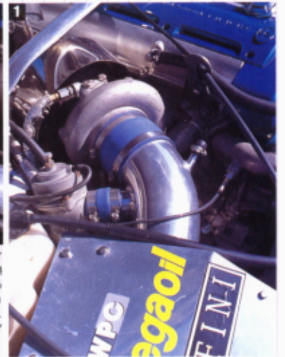
①ATミッションのため、タービンサイズをゆやみに大きくしてしまうとスタートがツラくなることから、TO4Rを選択している。②スロットルボディの調整は、SR16VEに交換することで対応している。コストも安く済むし、80の口径は使いやすい。
