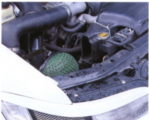
クリアランスレンズ部のダクトから入ったフレッシュエアは、そのままHKSパワーフィルターでろ過されることになる。カッコだけじゃないドレスアップなのだ
