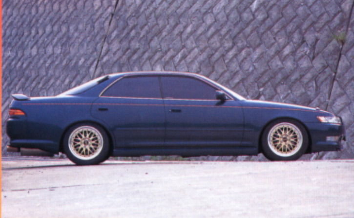
とりあえず出荷時の車高で組んでみた。フロント、リヤともに40mmのダウンとなる。タイヤとフェンダーの隙間は指1本分くらい。ワイルドなスタイリングだ
