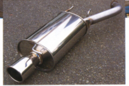
こちらはスタンダードマフラー。地味な耐熱塗装が施されているが、サイド部にデバイスが装着されている。アクセル開度とリンクして、ワイヤー駆動によりバイパスが開くシステムが採用
