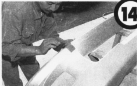
シリコンオフで油分をとり、サフェーサーをふく。仕上げ用のパテも盛る徹底ぶりだが、それがうまく塗装をノセるポイント
