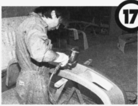
塗装を吹く。通常は塗装ブースでやってくれるが、今回は撮影の事情で、さっと同じ場所
