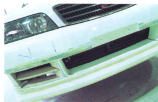
純正フォグランプを取り去り、スリットを設けたフロントバンパースポイラー。このスリットの奥には、インタークーラーが配置されている
