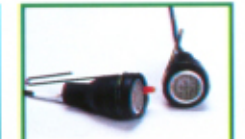
車内に超音波を流し、車内の物の動きを感知します。
