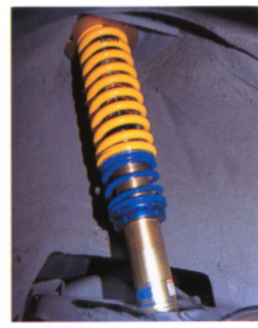
(右)フロントショックアブソーバーは大径ピストン採用の正立式ショートストローク。減衰力調整はアッパーマウント部で行う。スプリングのパネレートは12kg/mm。線径が太く、ピッチが細かい
