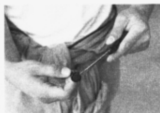
10mmのスパナでバンパーを外す。特殊な純正の留めネジはマイナスドライバーでヘッドを引っ掛けて外す
