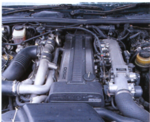
エンジンは吸・排気系とインテークのコンピューター、さらにブーストアップというライトチューン。それでもドリフトにはまずまずのパワーをマークする
