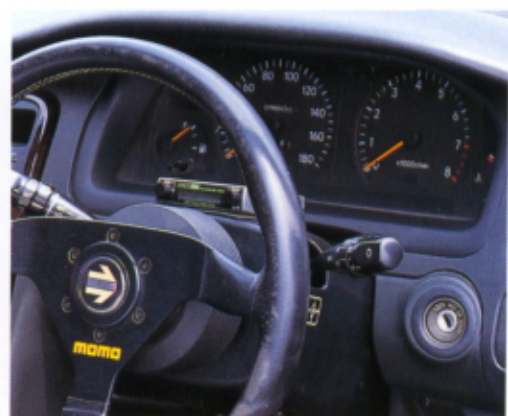
シンプルなインパネ周りだが、ステアリングコラム上に固定されたデュアルSBCでブーストは1.0 bar/caliに設定。使いやすいのはやはりココだということ
