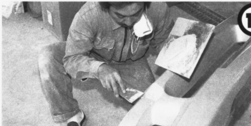
ポリパテを塗って、表面の処理を行う。患部はやや多く盛り込んでやる。その後、ドライヤーで乾かす
