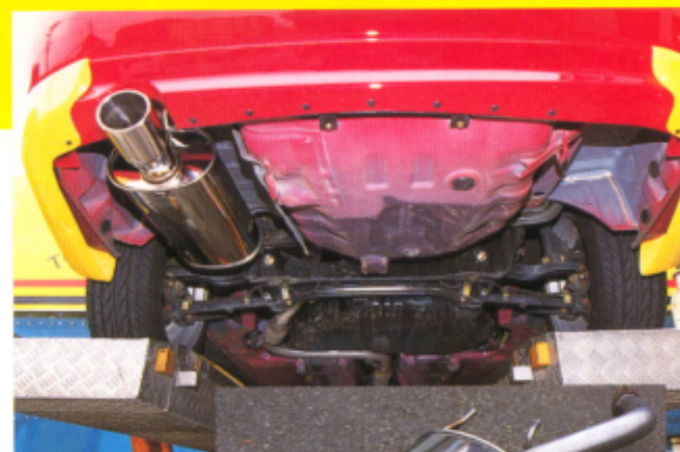
こちらはセダリスVR-G用。価格は5万6000円だ。何といてもSUS304材の輝き美しい。構成はエンドパイプとサイレンサーの一体構造で、サイレンサー内部はフジツボらしくストレート構造となっている。スタンダードと比較しても軽量化が果たされていて、出力特性と併せてメリットは非常に大きい
