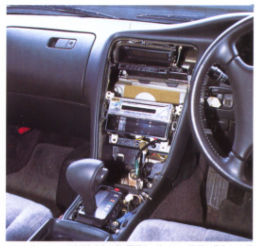
JZX90のコンソールを外したところ。配線や、ボックスが複雑に見えるが、基本を抑えておけばセルフインストールも十分可能。そのためには、エキスパートショップへ行くことが成功の鍵
