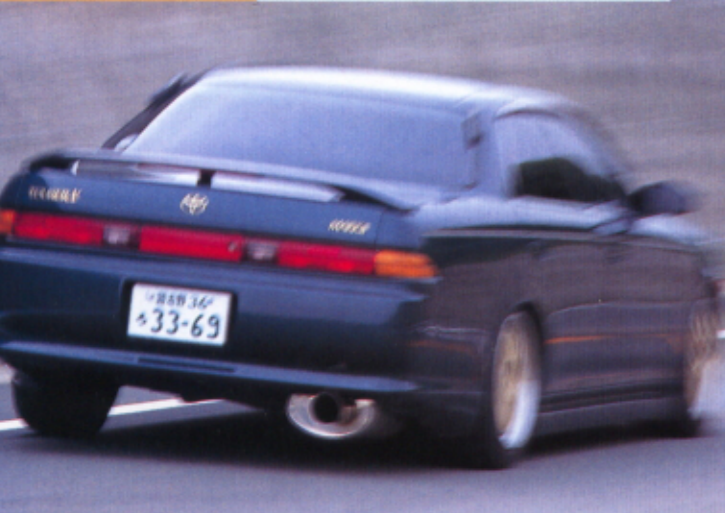
とりあえず出荷時の車高で組んでみた。フロント、リヤともに40mmのダウンとなる。タイヤとフェンダーの隙間は指1本分くらい。ワイルドなスタイリングだ
