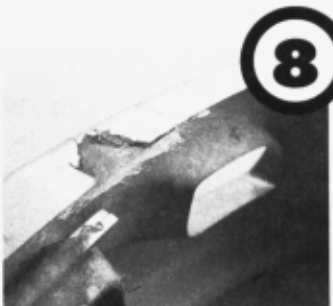
乾いたらアルミテープをはく。マットがハマ出した部分はカッターで切る
