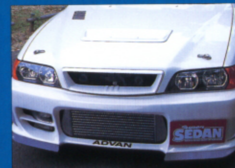
●大口径の吸入口が開けられたフロントスポイラー。サイドの小さなリップが微妙にサイドの整流、ダウンフォースを発生させる
