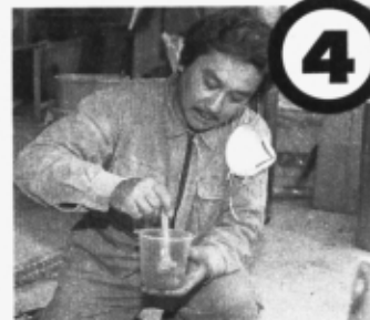
樹脂と硬化剤を100対1の割合で混ぜ合わせる。硬化剤を入れすぎると、硬化する際に熱を出すので良くない
