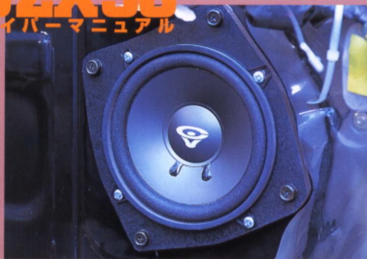
純正の位置にサーウィンペガを装着しているが、追加された4本のアンカーとフレームが確認できるだろう。ツイーターはAピラーの横へ、サーウィンペガ2525はペアで4万8000円。また、トランクルームにはランサーHBP210が設置される。5万7000円。これらの値段はパーツのみで、工賃は含まない
