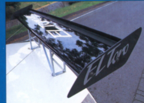
●カーボンとアルミパイプで形成されるリヤウイングは、高速走行時のダウンフォースをキッチリ得るセッティングアイテム。価格未定
