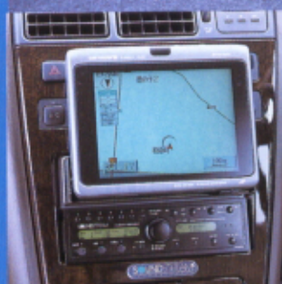
ナビのインストールのハスキーは得意中の得意種目。ヘッドユニットはサウンドストリームSTP-480 上がエクスタントのアンプで、その下の写真がCDチェンジャーとサブウーハー用のキャパシタ。インストールも美しいのだ
