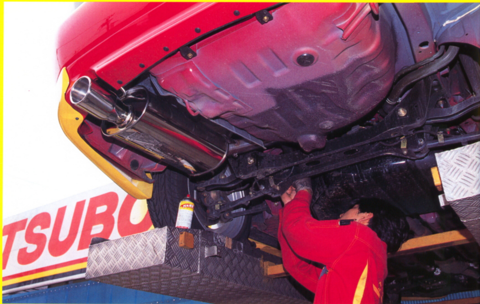
正確かつ迅速な作業でVR-Gに取り付けられるセダリスマフラー。今回、取材のご協力をいただいたのは、本文中でもご紹介している通り、藤巻技研の港北テストラボだ。セダリスマフラーに関する問い合わせは045-546-0321まで
