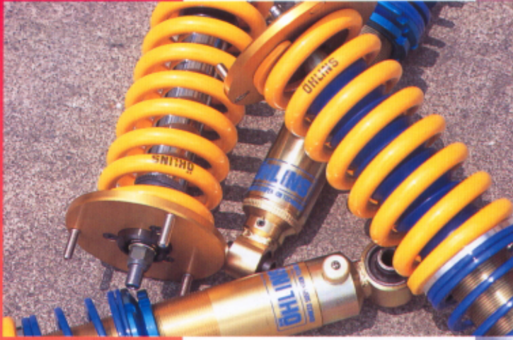
大径ピストンでオイル量を増やし、減衰力のボリューム感と耐久性のアップを図るなど、オーリンズのこだわりが機能美を感じさせる。オーバーホール、仕様変更も可能
