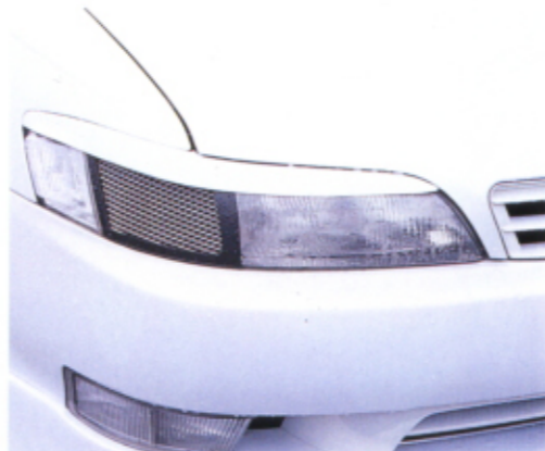
クリアランスレンズ部を加工してエアインテークとして使っている。このあたりの加工技術やアイデアがこのクルマの完成度を高めている重要なのである
