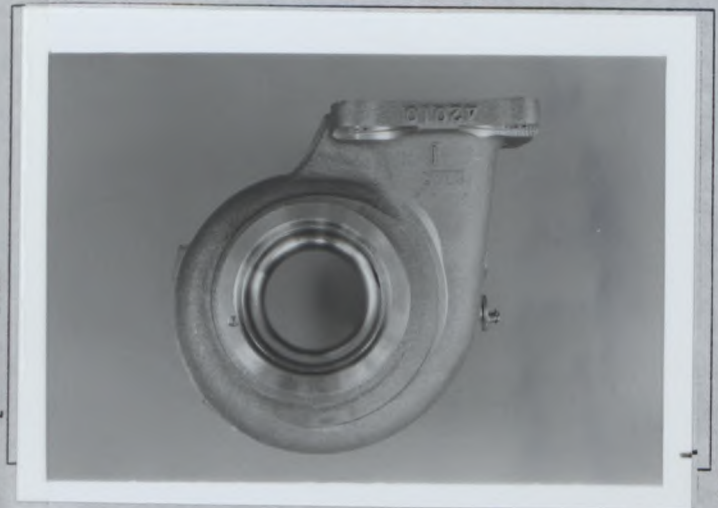
N) Turbine housing of turbocharger ターボチャージャーのタービンハウジング
